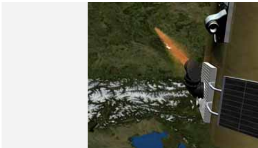
TerraSAR-X sendet Daten per Laserstrahl
