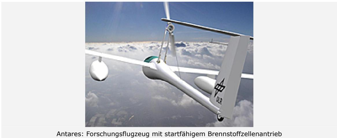
Antares: Forschungsflugzeug mit startfähigem Brennstoffzellenantrieb
