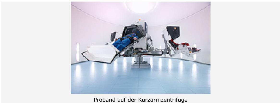
Die rund 2,9 Tonnen schwere und mit zwei Sitzen und zwei Liegen ausgestattete Experimenteinrichtung kann bei 45 Umdrehungen in der Minute eine maximale Erhöhung der Schwerkraft auf 6,4g (Gravitation) erzeugen, also mehr als das Sechsfache des Körpergewichts eines Probanden.
