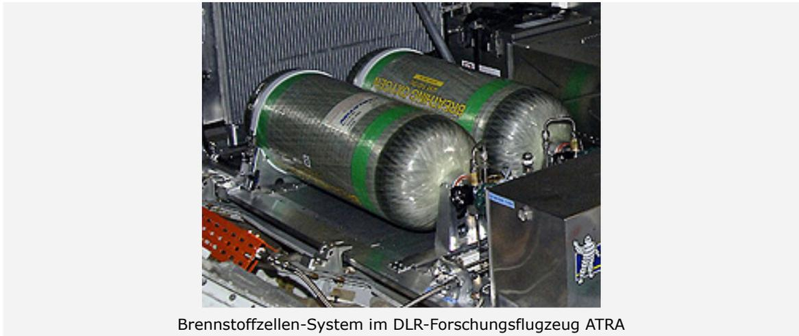
Brennstoffzellen-System im DLR-Forschungsflugzeug ATRA
