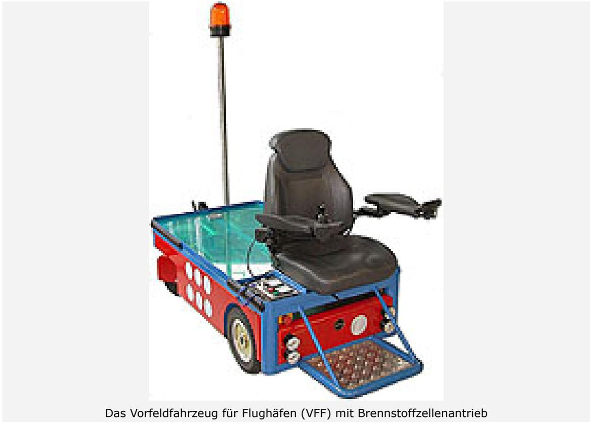
Das Vorfeldfahrzeug für Flughäfen (VFF) mit Brennstoffzellenantrieb
