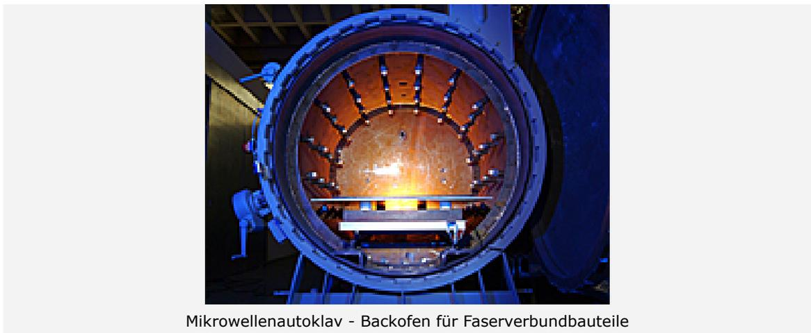
Mikrowellenautoklav - Backofen für Faserverbundbauteile
