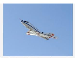
Die bewährte Falcon des DLR ermittelt mit einem nach unten gerichteten Laserstrahl die Aerosolverteilung.
