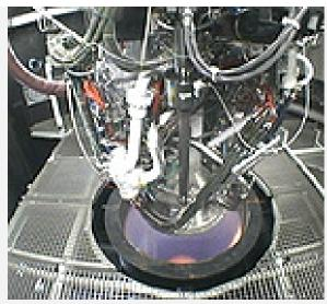
Vinci-Triebwerk während des Testlaufs im Höhenprüfstand P4.1
