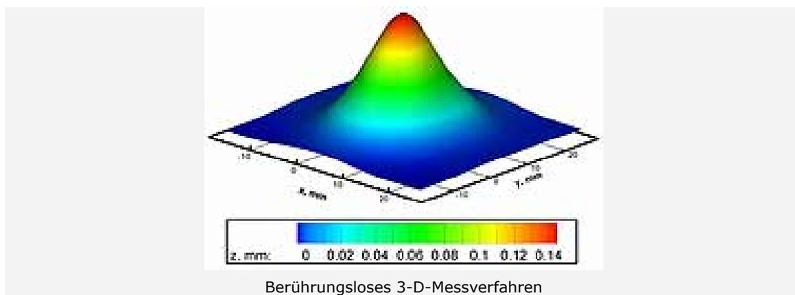
Die Projected Pattern Correlation-Technik ist ein berührungsloses 3-D-Messverfahren, das Deformationen von diffus streuenden Oberflächen räumlich vermisst. Die erzielbare Messgenauigkeit liegt im Mikrometer-Bereich. Eine Anwendungsmöglichkeit ist zum Beispiel die Rauheitsmessung zur Klassifikation von Oberflächen.
