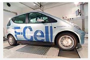
Der Prüfstand des DLR in Stuttgart ist allradtauglich
