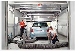
Neuer Allradrollenprüfstand des DLR in Stuttgart
