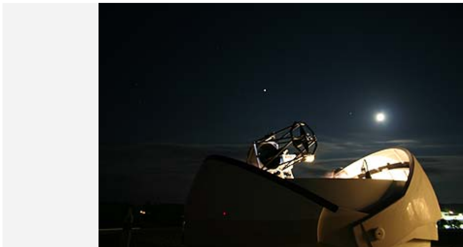
Transportable Station zur optischen Freiraumkommunikation
