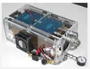
Das Kernmodul: PEFC-Brennstoffzelle mit 0,5 Kilowatt Nennleistung
