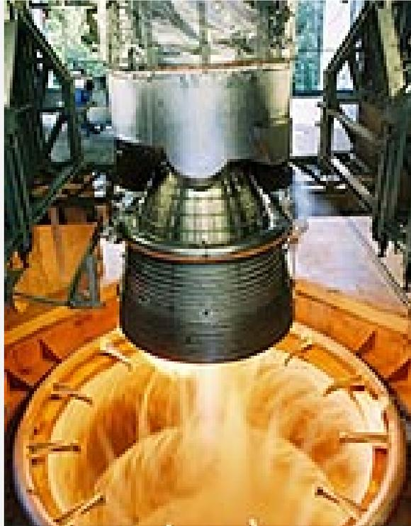
Vulcain 2 - Hauptstufentriebwerk der Ariane 5
