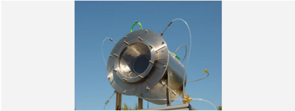
Reaktor für die solare Erzeugung von Wasserstoff am DLR-Sonnenofen in Köln-Porz
