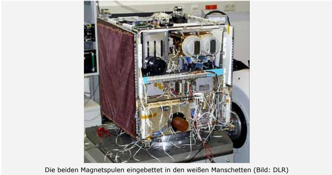
Die beiden Magnetspulen eingebettet in den weißen Manschetten (Bild: DLR)
