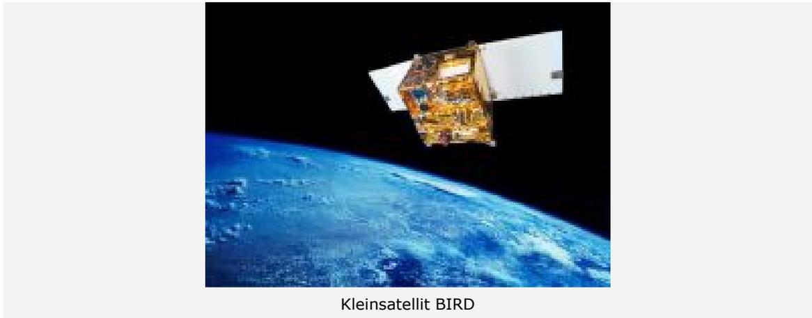
**Weltweit erstmalig neue Technologie zum Einsatz gebracht - BIRD nur durch Erdmagnetfeld stabilisiert**
