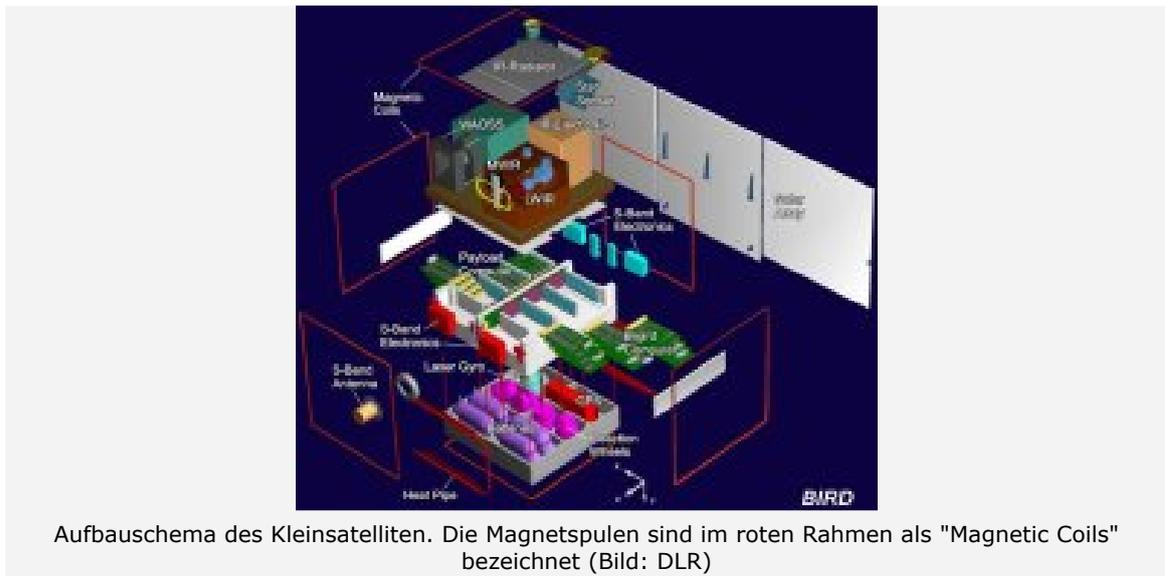
Aufbauschema des Kleinsatelliten. Die Magnetspulen sind im roten Rahmen als "Magnetic Coils" bezeichnet (Bild: DLR)
