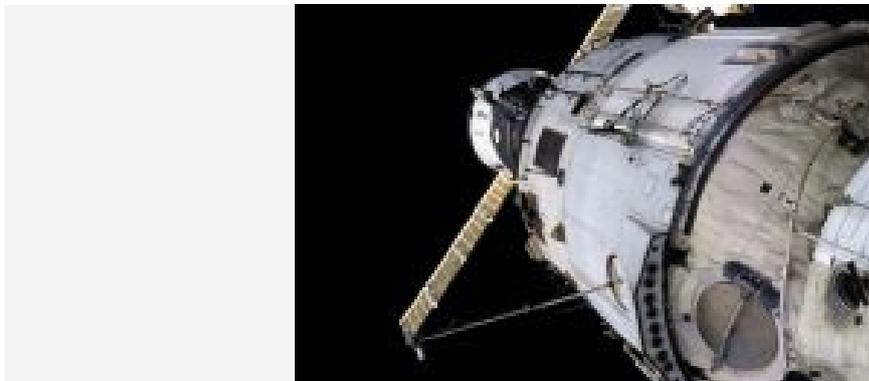
Das Service-Modul Swesda der Internationalen Raumstation ISS mit angedocktem Progress-Versorgungsraumschiff
