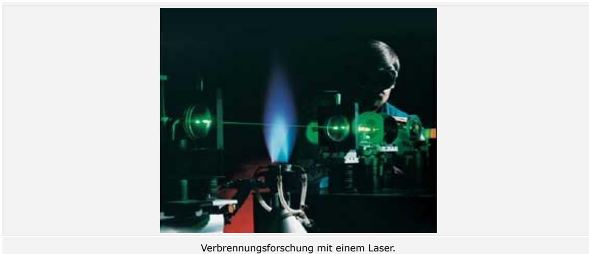
Verbrennungsforschung mit einem Laser.
