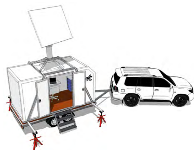
Von der mobilen Bodenstation aus werden die Missionen des Stratosphärenflugzeugs HAP alpha koordiniert.
