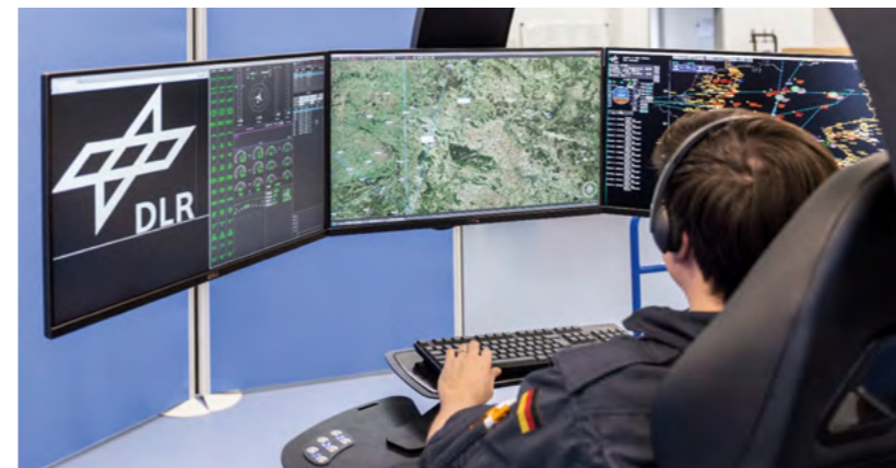
Anders als bemannte Flugzeuge werden HAPs von der Bodenstation aus gesteuert. Sogenannte Remote Pilots müssen sich dabei auf unterschiedliche Informationen verlassen: etwa die über Status und Kurs des Flugzeugs wie auch jene zu den überflogenen zivilen Lufträumen.
