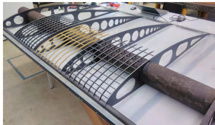
Die Flügel der Plattform bestehen aus einer Sandwichrippenstruktur aus kohlenstoffaserverstärkten Kunststoffen (CFK). Ein CFK-Rundrohr bildet die Basis. Das macht den Flügel leicht und stabil. Insgesamt wiegt die Struktur der HAP alpha 36 Kilogramm, 75 Prozent davon der Hauptflügel.
