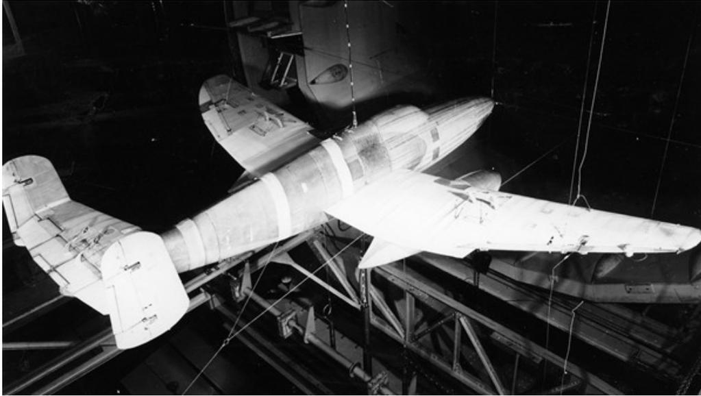
Modell des ersten zweistrahligen Düsenflugzeuges im Göttinger Windkanal: Ohain entwickelte die Triebwerke für die Heinkel 280. Das Flugzeug wurde in einem Windkanal der AVA, Vorgänger des heutigen Deutschen Zentrums für Luft- und Raumfahrt (DLR) in Göttingen, untersucht. Die Maschine flog erstmals 1941.
